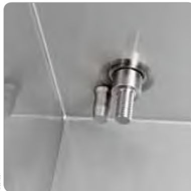
Монтажная плата устанавливается на 4 ступенчатых болтах 10 мм
