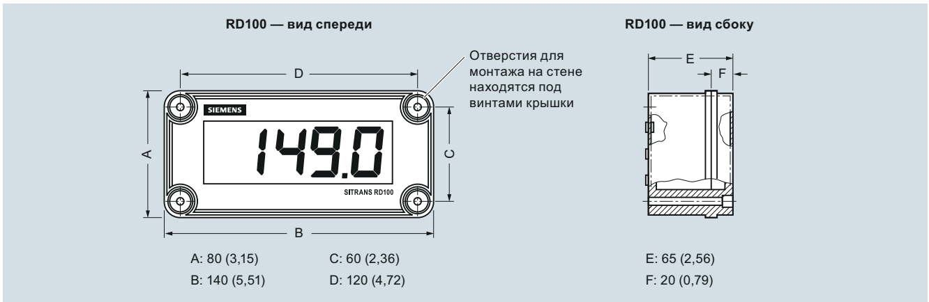
SITRANS RD100, размеры в мм (дюймах)
