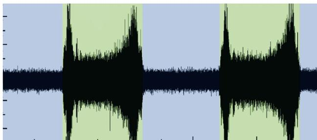
Сигнал от датчика структурного шума при поврежденном клапане
