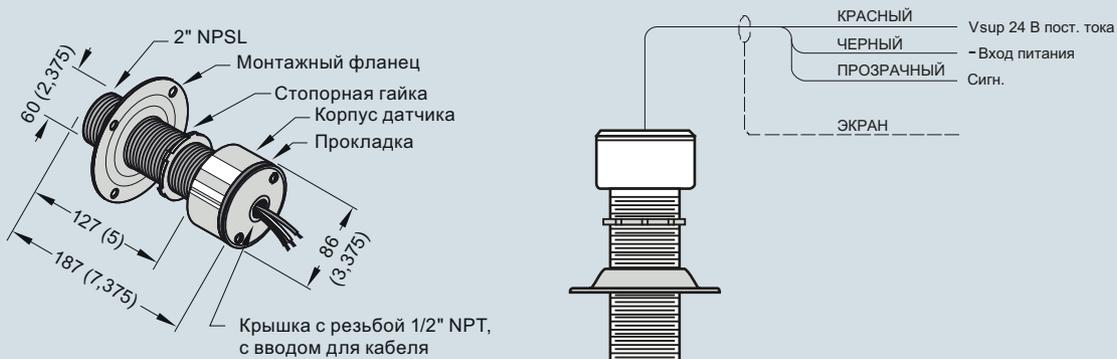
Датчик, размеры в мм (дюймах)
