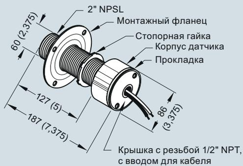
MFA 4p и датчики, размеры в мм (дюймах)
