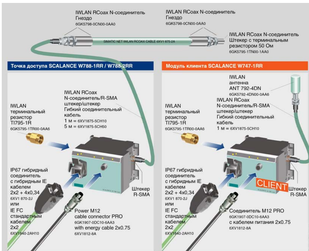
Использование IWLAN RCoax кабельной системы для подключения мобильной установки на основе PROFINET IO к проводным каналам связи Industrial Ethernet
