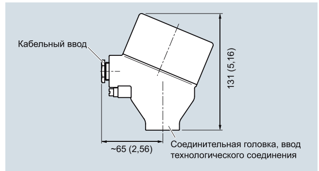
Соединительная головка с дисплеем и стеклянной крышкой, алюминий, тип AH0, нержавеющая сталь, тип AV0, размеры в мм (дюймах)
