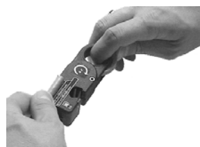
Измерение участка кабеля, с которого будет удаляться изоляция.
