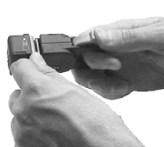
Кабель зажимается с помощью фиксатора.
