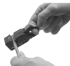
Выполняется 4 вращательных движения по направлению стрелки на корпусе устройства.
